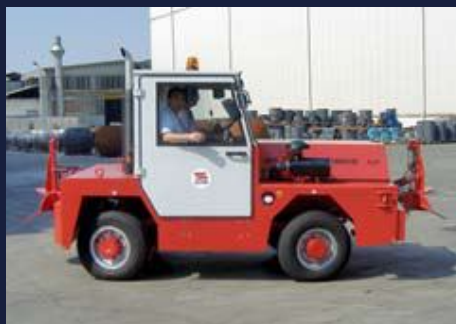
Полноприводная версия для уменьшения радиуса поворота.
