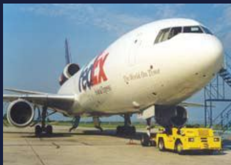
Низкопрофильная версия (без кабины) для перемещения самолетов.
